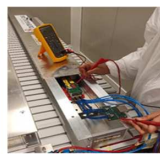
การตรวจสอบทางอิเล็กทรอนิกส์ก่อนติดตั้ง stave บน Outer barrel
