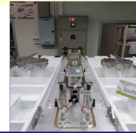
หัว sputtering เคลื่อนกระจกใน ห้องสุญญากาศ
