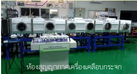
หัว sputtering เคลื่อนกระจกใน ห้องสุญญากาศ
