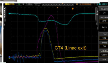
ตัวอย่างผลการผลิตลำอิเล็กตรอนพลังงาน 8 MeV กระแส 135 – 144mA
