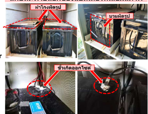
ลักษณะภายนอกของแบตเตอรี่ที่เสื่อมสภาพ
