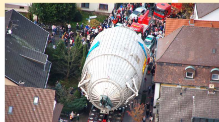
ภายนอกของmain spectrometerเส้นผ่าศูนย์กลาง 10 เมตร ขณะขนส่ง
