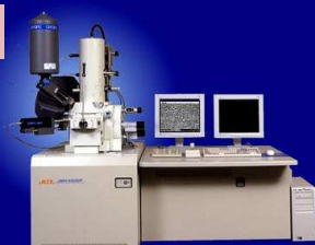
กล้องจุลทรรศน์ที่ใช้อิเล็กตรอนแทนการใช้แสงในการให้เกดภาพ
