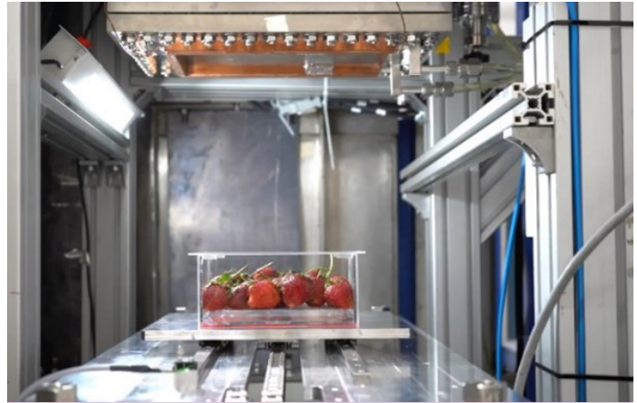
การทดสอบฉายรังสีเอกซ์บนสตรอเบอร์รี่ด้วยเครื่องเร่งอนุภาค
