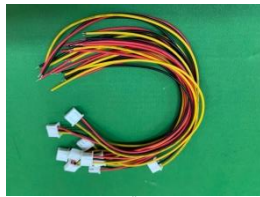
สายไฟจัมเปอร์
