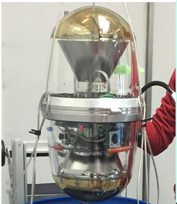
นักศึกษาไทยร่วม IceCube Bootcamp 2024 เพื่อประกอบ ทดสอบและวิเคราะห์โมดูลแสงยาว (LOMs) รวมถึงแบ่งปัน ประสบการณ์กับทีมวิจัย โครงการ IceCube Gen 2
