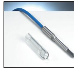
หัววัดรังสีแบบมาตรฐานที่ใช้ในศูนย์รังสีรักษา แต่ทว่ามีปัญหาเมื่อถูกใช้ในการวัดรังสีที่มีการถ่ายเทพลังงานอย่างรวดเร็ว แบบFLASH(รัศมี 6 mm และยาว 2 cm)
